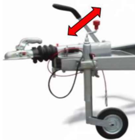
Obr. 5. Nastavení páky ruční brzdy přívěsu
