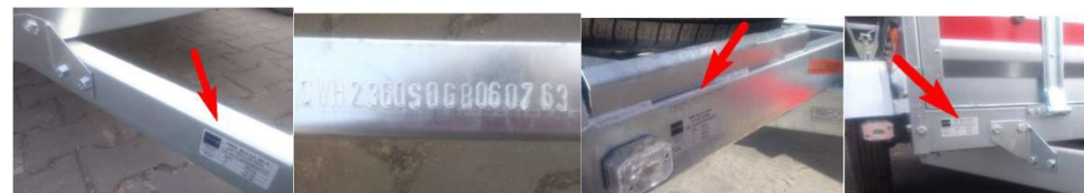
Obr. 1. Umístění výrobního štítku přívěsu
