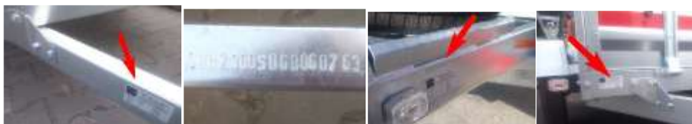
Obr. 1. Umístění výrobního štítku přívěsu
