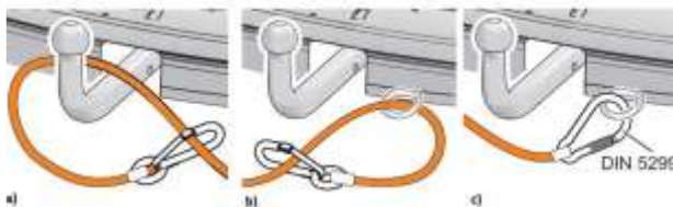
Obr. 6. Připevnění bezpečnostního lanka
