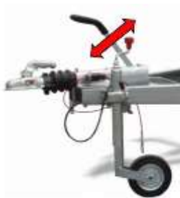
Obr. 5. Nastavení páky ruční brzdy přívěsu
