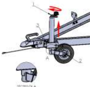
Obr. 4. Schéma činnosti opěrného kola
