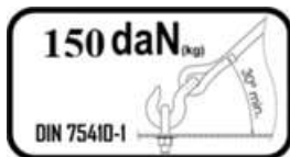
Obr. 2. Principy zatížení kotvicích ok
