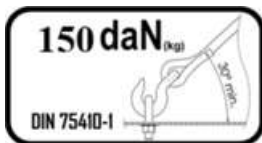
Obr. 2. Principy zatížení kotvicích ok
