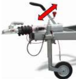
Obr. 5. Nastavení páky ruční brzdy přívěsu
